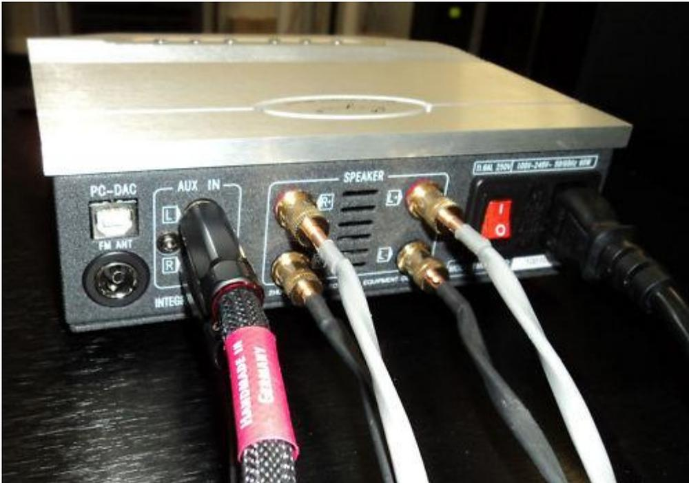
Wie auf dem obigen Foto zu sehen verfügt der Cayin MM-2 über ein solides und sauber verarbeitetes Metallgehäuse mit massiven Alu-Front/Deckeln. Ebenfalls zu sehen sind die hochwertigen Lautsprecherklemmen und ein Hauptnetzschalter der das Gerät komplett vom Stromnetz trennt (kein Standby Stromverbrauch).
