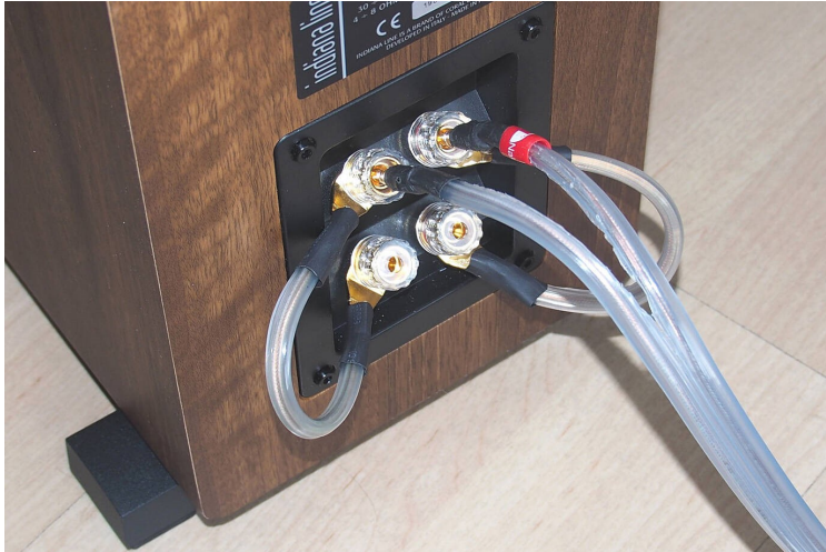
Anschluss mit Kabelbrücken
