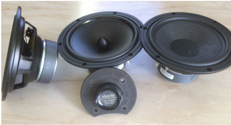
Die ausgebauten Chassis: Rechts und links die Bass-Treiber, dazwischen der Mitteltöner und vorn die Rückseite des Tweeters.
