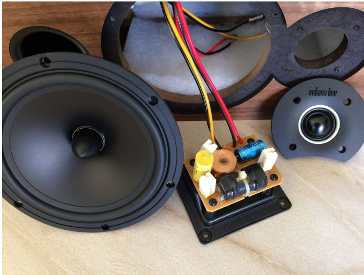
Ausgebaut: Die Chassis der Box mit der Frequenzweichen-Platine
