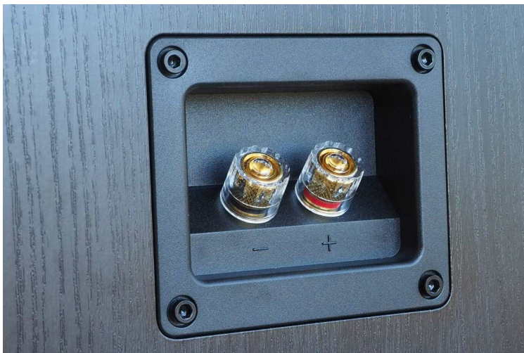
Das Single Wiring Terminal trägt Anschlussklemmen guter Qualität
