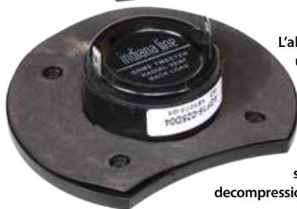
L'altoparlante è fissato su una flangia molto ampia di raccordo fra pannello e woofer, con i centri di emissione ravvicinati. Il magnete è in neodimio, la cupola in seta trattata e la camera di decompressione posteriore con sistema di dissipazione è stata messa a punto da Indiana Line per abbassare la frequenza di risonanza e assorbire le riflessioni sulla membrana.
