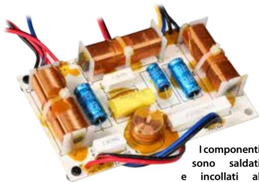
I componenti sono saldati e incollati al PCB fissato sulla parete di fondo e collegati alla vaschetta dei contatti. Il condensatore in serie al tweeter è in poliestere metallizzato, gli altri di tipo elettrolitico e gli induttori a bassa Re sono avvolti su lamierini.
