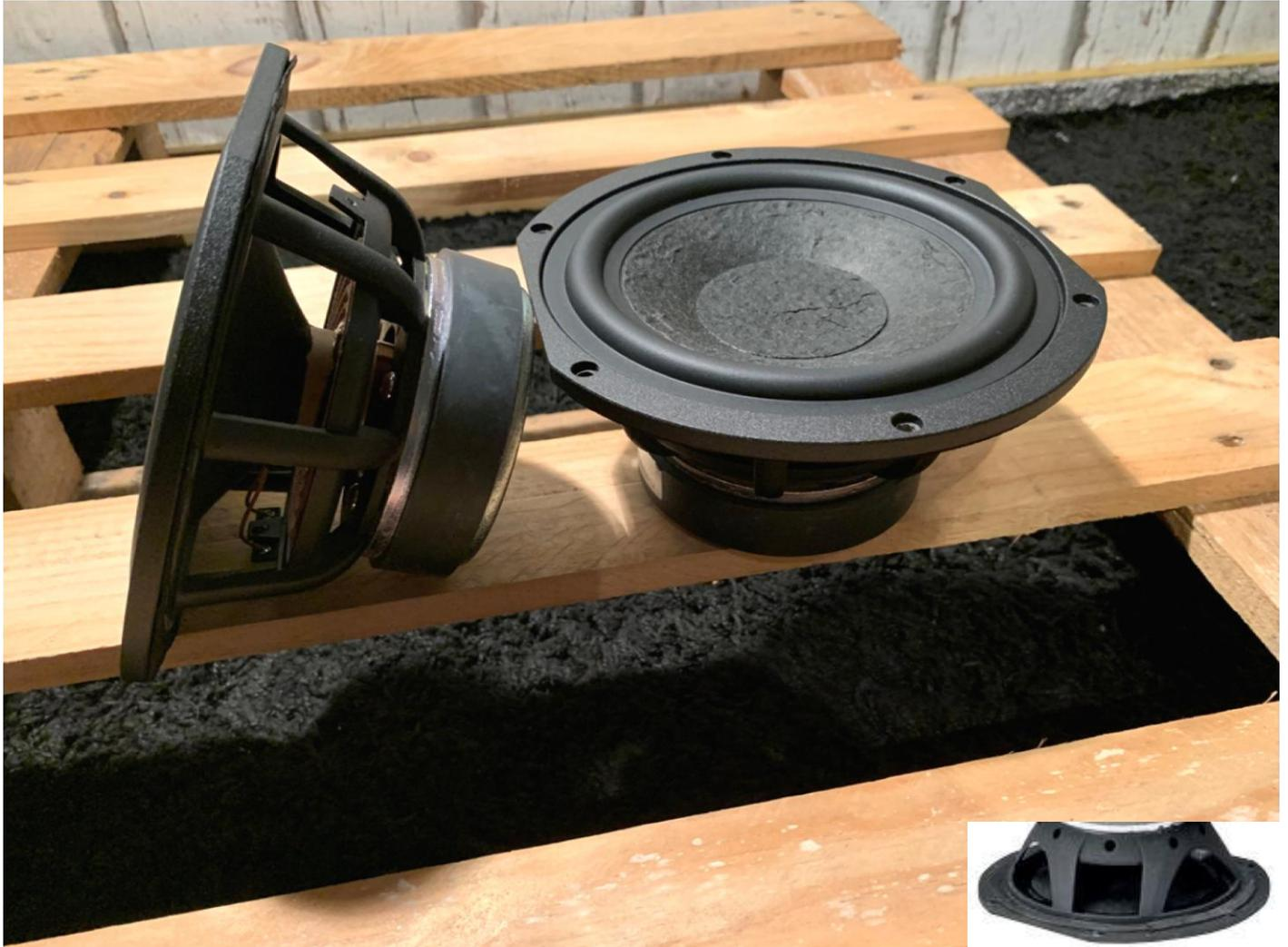
Parallel arbeiten die beiden **neuen 18 cm messenden Tieftöner** im Basskeller. So addieren sich dessen Membranflächen zu einem quasi 25 cm großen Chassis. Das verspricht einen vollmundigen Bass. Schon von außen ist zu sehen, dass der Korb zu den Seiten abgeflacht ist. Durch diesen einfachen Kniff werden 2 cm Gehäusebreite eingespart. Das kommt den Proportionen zu Gute und trägt zur gelungenen Optik der indiana line Diva 660 bei.
