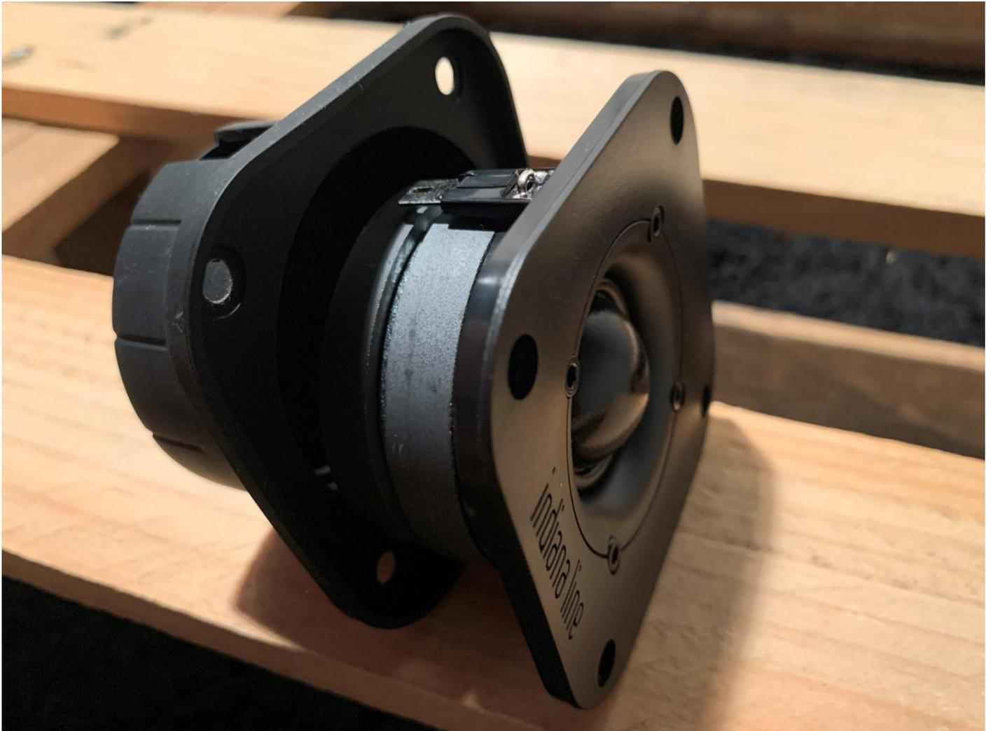
Die Schwingspule taucht in den Luftspalt von einem - für einen Hochtöner - **sehr kräftigen Magnetsystem** ein. Zusätzlich befindet sich in dem Luftspalt „Ferrofluid“. Das Ferrofluid sorgt für eine bessere Wärmeableitung der Schwingspule. Dadurch wird die Schwingspule auch bei hohen Belastungen in einem idealen Temperaturfenster gehalten.
