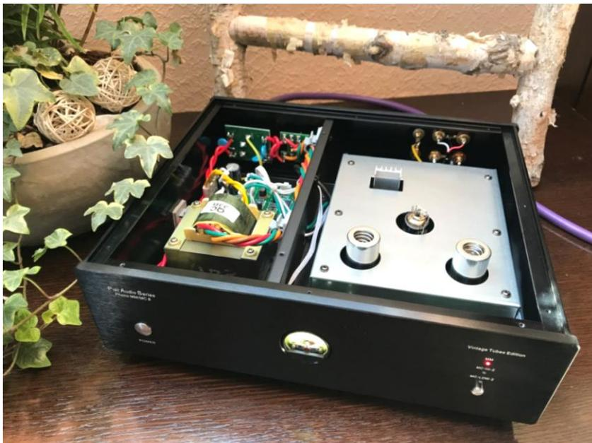
Die **Verstärkungssektion** wird vom kräftigen, stabilen Netzteil getrennt und nochmals bestens **abgeschirmt**.
