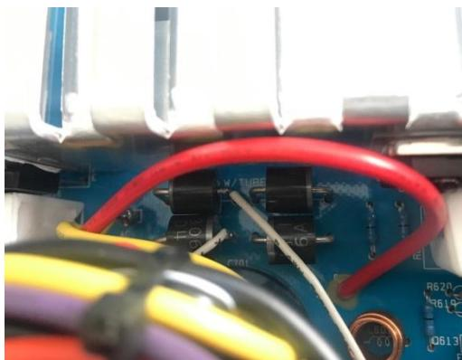
Alles beginnt mit dem großzügig dimensionierten **Ringkerンtrafo** (links oben). Sekundärseitig gehen die Kabel in der Mitte des Kühlkörpers zur Platine. Einzelne, schnelle Dioden (Detailbild links) sorgen für die positive und negative Gleichspannung. Diese wird mit Hilfe der beiden **Kondensatoren (20.000 Mikrofarad Siebkapazität, Bildmitte)** geglättet und stabilisiert. Mit +/- 29 Volt werden die beiden Paare (je Kanal) der sehr angesehenen **Sanken Transistoren**, spannungstechnisch versorgt.
