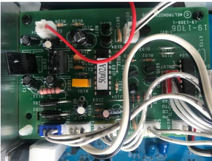
Die Umschaltung der Quelle erfolgt auf der nebenstehenden grünen Platine elektronisch (verschleißfrei) durch einen Chip.
