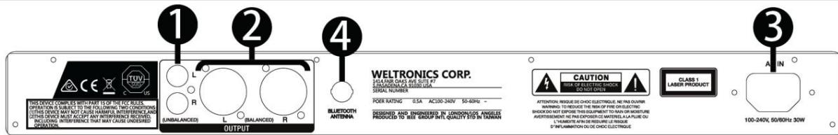
1. **Ausgänge (unsymmetrische Cinch-Anschlüsse):** Diese Ausgänge geben die Audiosignale von einem CD-Player, Bluetooth-Gerät oder USB-Gerät (Massenspeicher) aus. Klasse) und Gerät, das an den Aux-Eingang angeschlossen ist. Verwenden Sie RCA-Kabel, um diese Ausgänge mit externen Lautsprechern zu verbinden. Soundsystem usw. Weitere Informationen finden Sie [unter Einrichtung](#).
